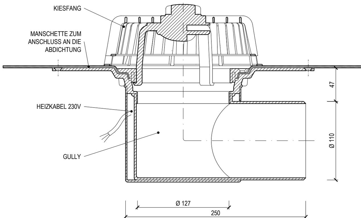
\_\_\_ = standard manschette BIT und PVC, manschetten auf bestellung - FPO/TPO, EPDM, POCB, STE, PE
