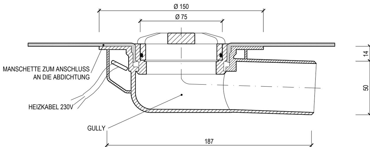
\_\_\_ = standard manschette BIT und PVC, manscheten auf bestellung - FPO/TPO, EPDM, POCB, STE, PE
