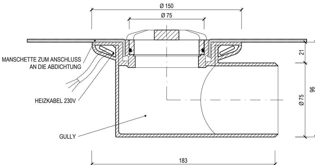
\_\_\_ = standard manschette BIT und PVC, manscheten auf bestellung - FPO/TPO, EPDM, POCB, STE, PE
