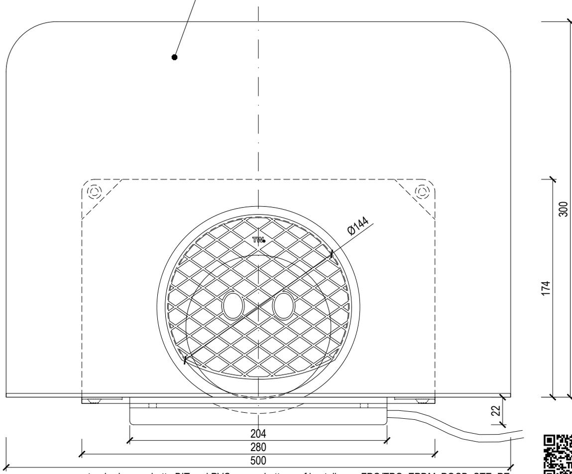
\_\_\_ = standard manschette BIT und PVC, manschetten auf bestellung - FPO/TPO, EPDM, POCB, STE, PE
