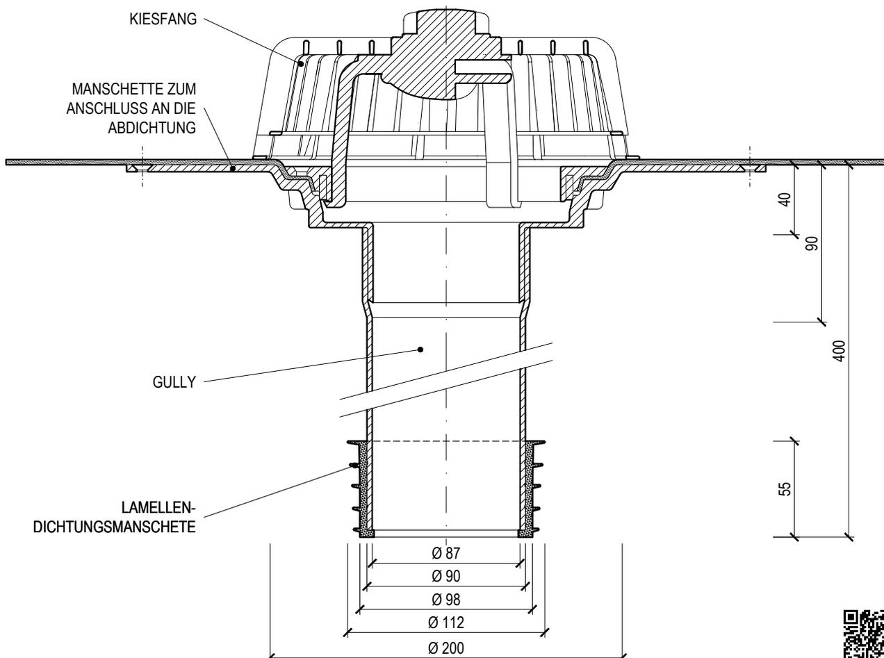
\_\_\_ = standard manschette BIT und PVC, manschetten auf bestellung - FPO/TPO, EPDM, POCB, STE, PE
