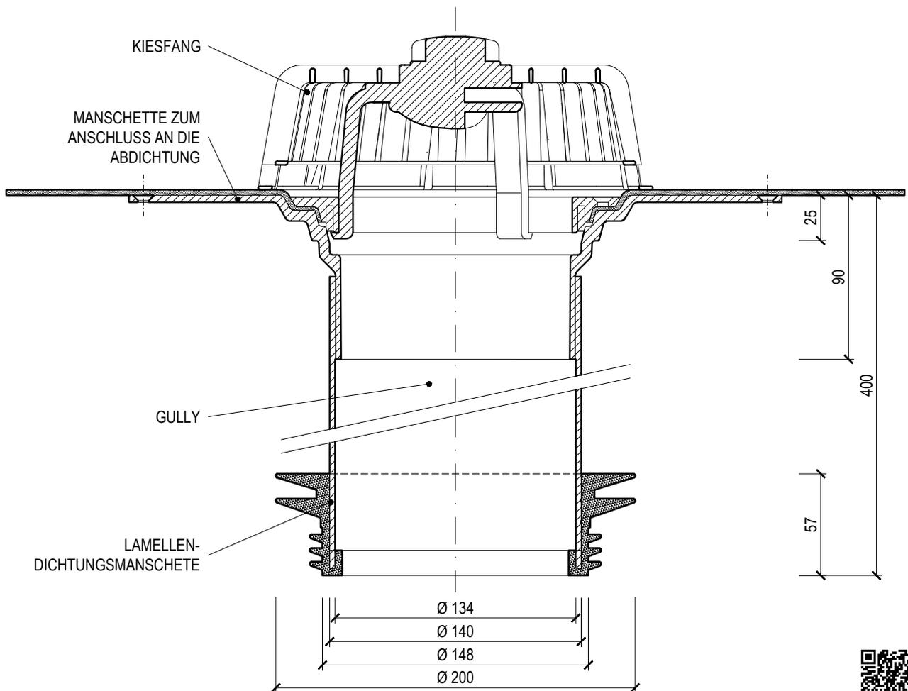
\_\_\_ = standard manschette BIT und PVC, manschetten auf bestellung - FPO/TPO, EPDM, POCB, STE, PE
