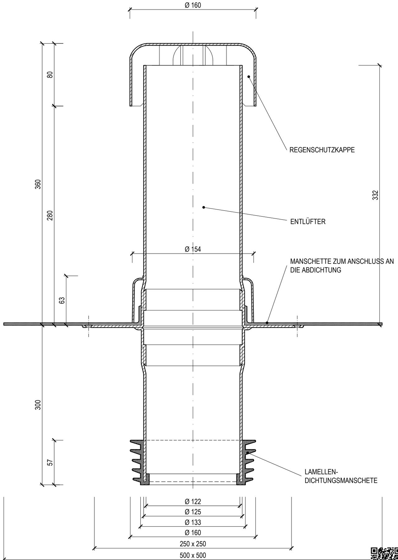
\_\_\_ = standard manschette BIT und PVC, manschetten auf bestellung - FPO/TPO, EPDM, POCB, STE, PE
