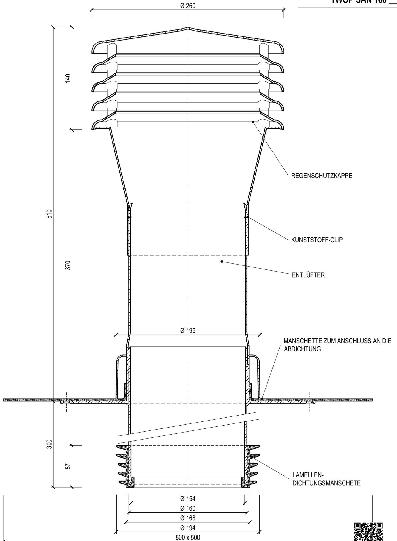
\_\_\_ = standard manschette BIT und PVC, manschetten auf bestellung - FPO/TPO, EPDM, POCB, STE, PE
