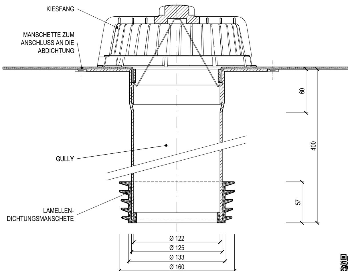
\_\_\_ = standard manschette BIT und PVC, manschetten auf bestellung - FPO/TPO, EPDM, POEB, STE, PE
