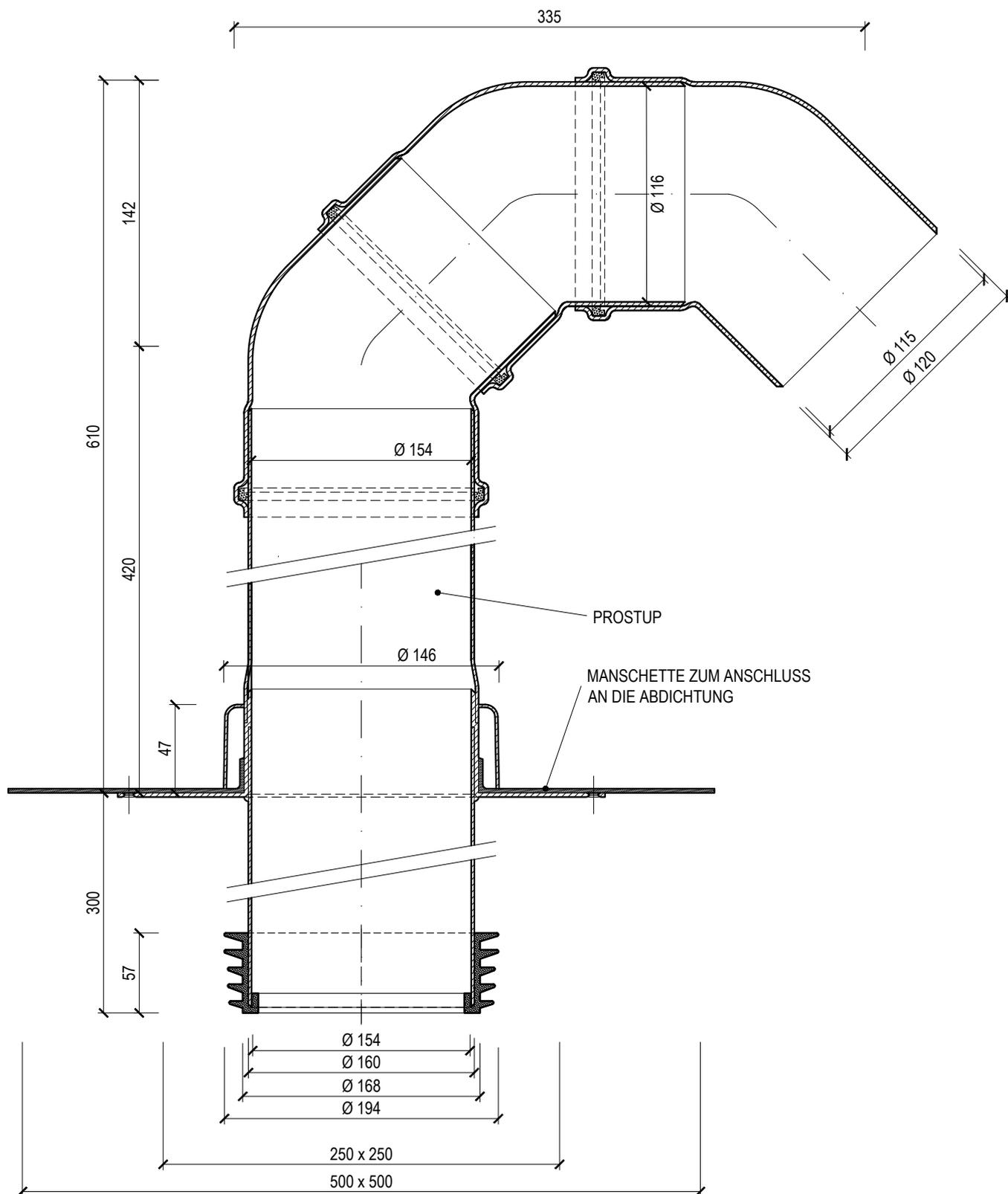
\_\_\_ = standard manschette BIT und PVC, manschetten auf bestellung - FPO/TPO, EPDM, POCB, STE, PE
