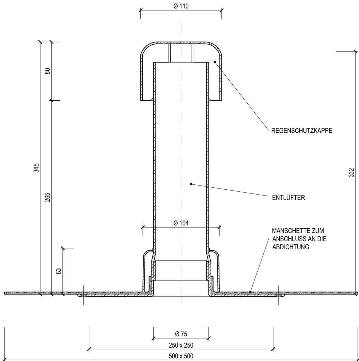
\_\_\_ = standard manschette BIT und PVC, manschetten auf bestellung - FPO/TPO, EPDM, POCB, STE, PE
